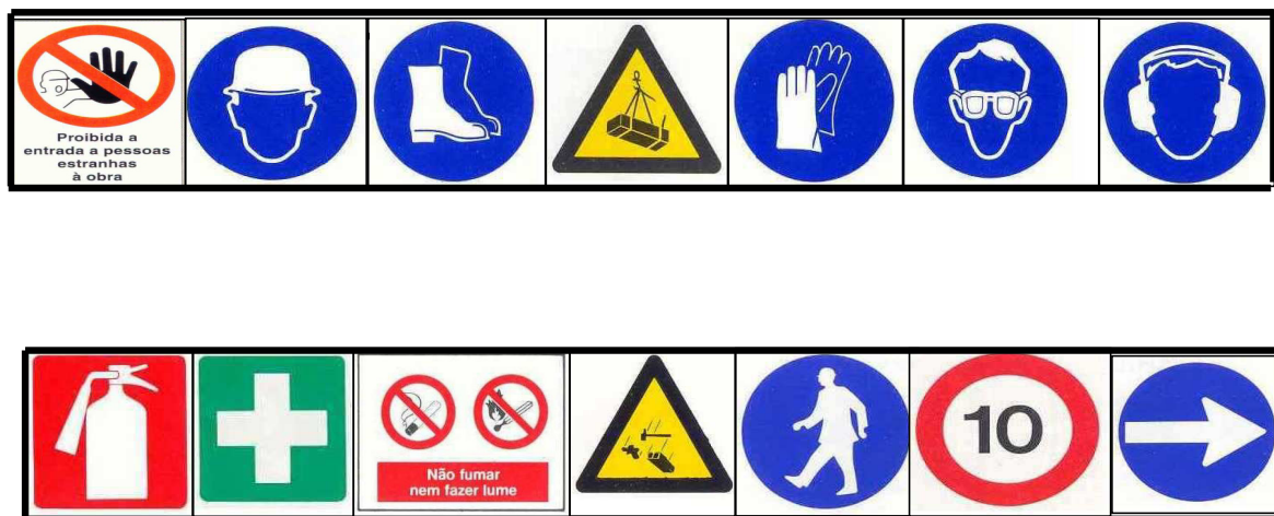
Figura 6.1 – Sinalização de estaleiro
